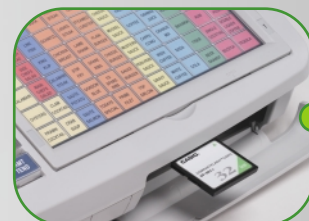
Ingebouwde Compact Flash kaartlezer vereenvoudigt opslaan/herstel van gegevens
